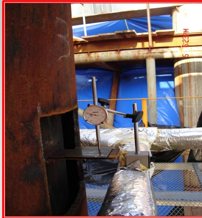
Detalle de la instalación de uno de los cuatro micrómetros con carrera de 1" (2.54 cm) para el registro de los desplazamientos
