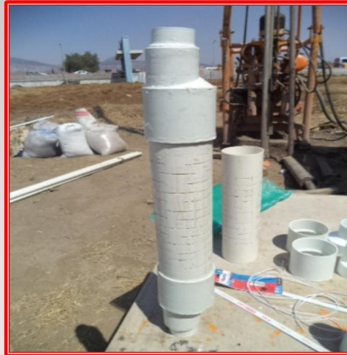
**Piezómetro abierto de Casagrande, para
