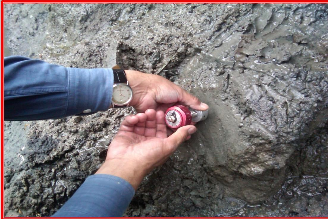
Obtención en campo de la resistencia al corte empleando el torcómetro de bolsillo en suelos blandos
