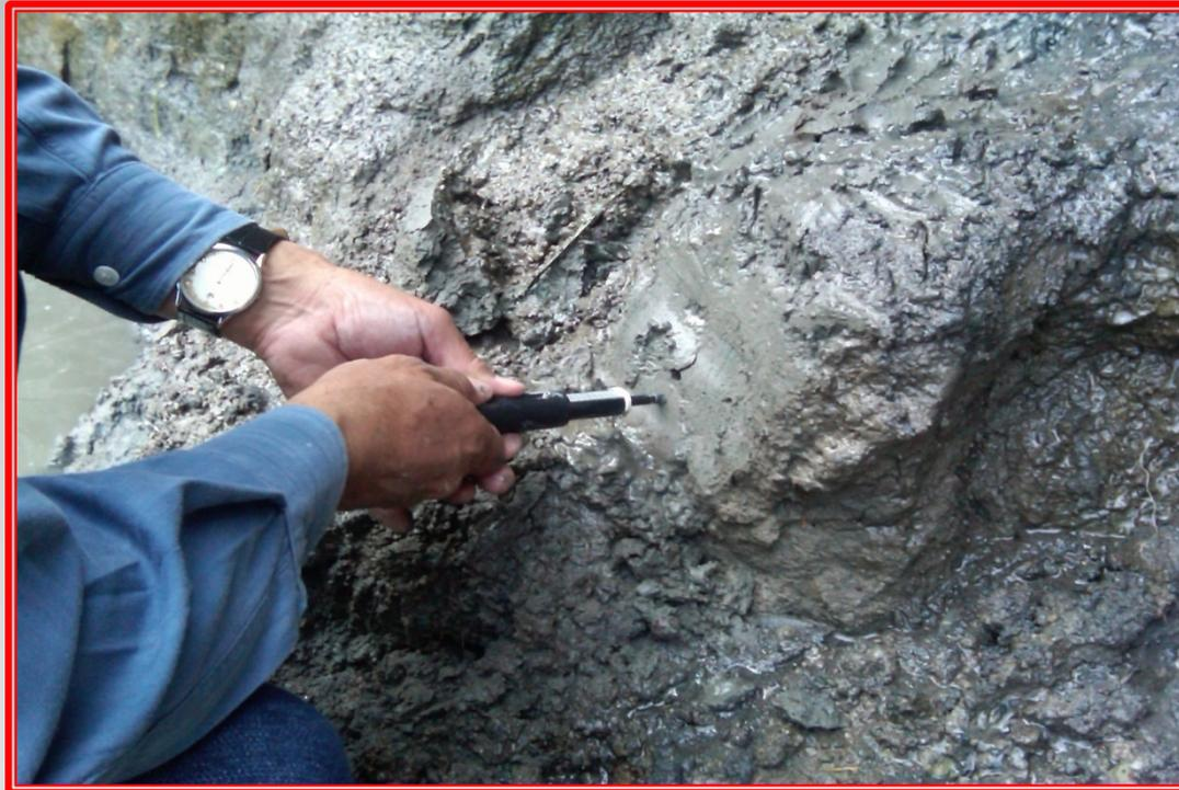
Medición en campo de la resistencia del suelo en las paredes de una excavación mediante el penetrómetro de bolsillo
