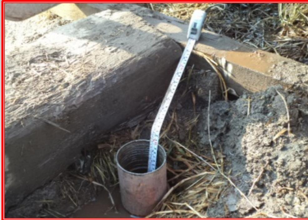
Medición de la variación del nivel del espejo del agua
