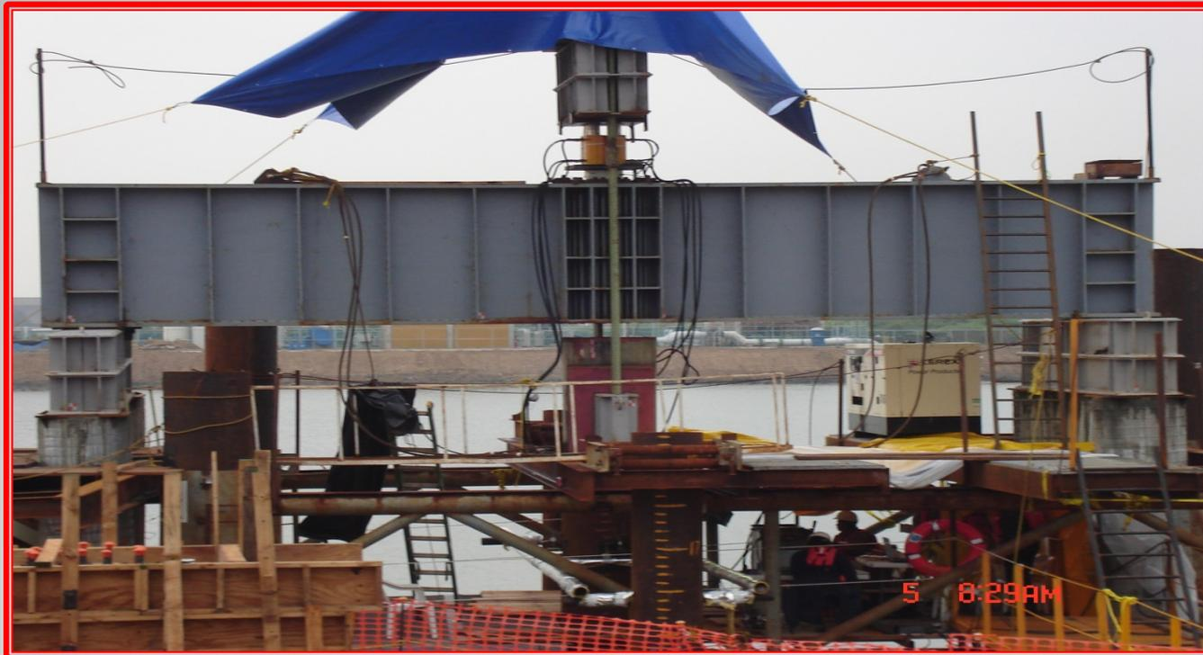
Arreglo General de una Prueba de Carga a Tensión en una Pila de 91 cm de diámetro desplantada a 17 m de profundidad en el Puerto de Altamira, Tamaulipas
